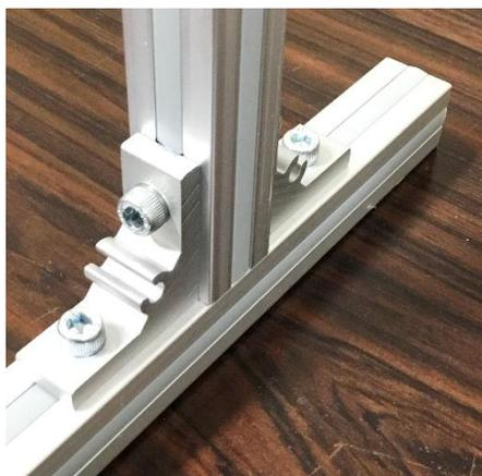
フレームの隙間には、樹脂部品（端材）を埋め込んでおり、ホコリが溜まらず爪で引っかけるなどのトラブルを防止できます。
